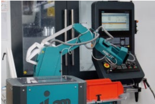
Bild 4: ...und startet mit präzisiertem Druck auf den Startknopf den Fräsprozess.
