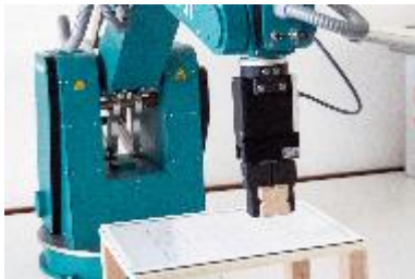
Bild 5: ...und setzt den Würfel richtig orientiert in ein vorbestimmtes Feld. Diesen Zyklus führt HORST so lange aus, bis alle Felder befüllt sind.
